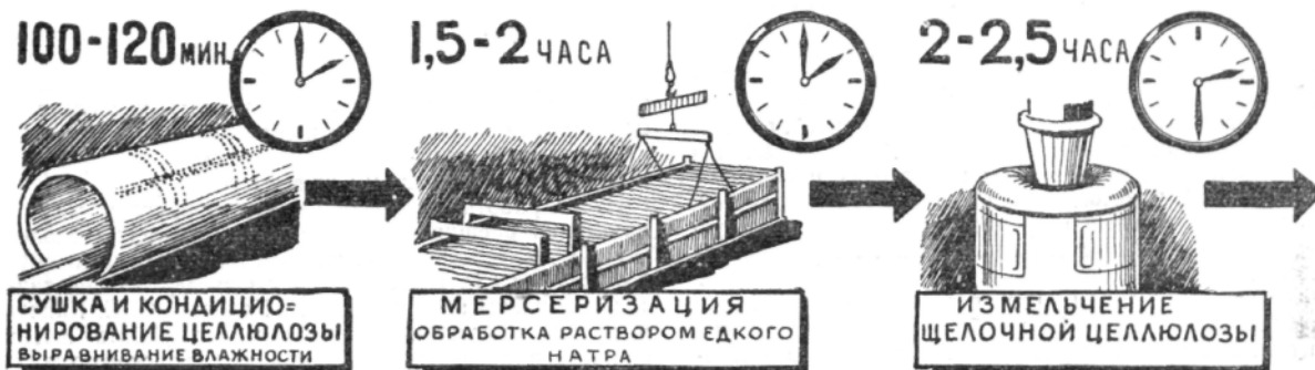
Схема получения вискозы из древесной целлюлозы.
