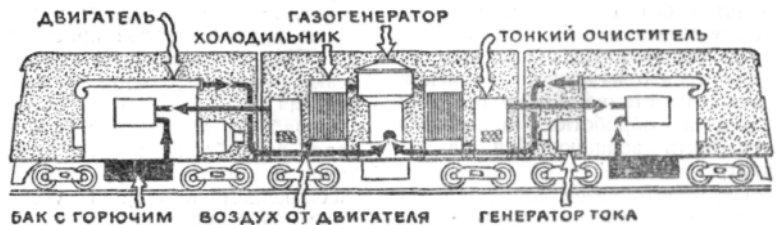
Схема газогенераторного тепловоза «ТЭ-2».
